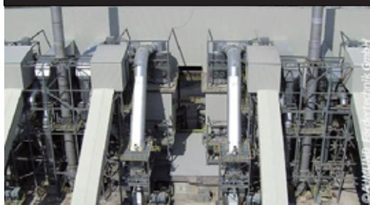
4 台の堅型ミルへクリンカーを搬送する 4 台の AUMUND KZB 型バンコンペアー
